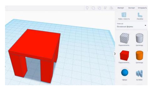
Теперь делаем его более вытянутым. Нажимаем на кнопку разгруппировать элементы. Выделяем отдельно сидень и вытягиваем. Затем опять идет сгруппировка. Справа у нас есть характеристики модели. Выбираем цвет и перекрашиваем в фиолетовый. Выделяем табурет. Нажимаем копировать, вставить. Получили 2 штуки.
