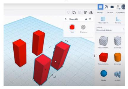
Теперь делаем сиденье для табурета. Вытаскиваем параллелепипед. Рястягиваем его по размерам с ножками и делаем немного плоским. С помощью черного конуса над моделью поднимаем сиденье вверх и собираем табурет. Теперь выделяем его полностью и в правом углу находим кнопку сгруппировать, чтобы он получился цельным. Теперь элементы будут перетаскиваться не по отдельности, а вместе.
